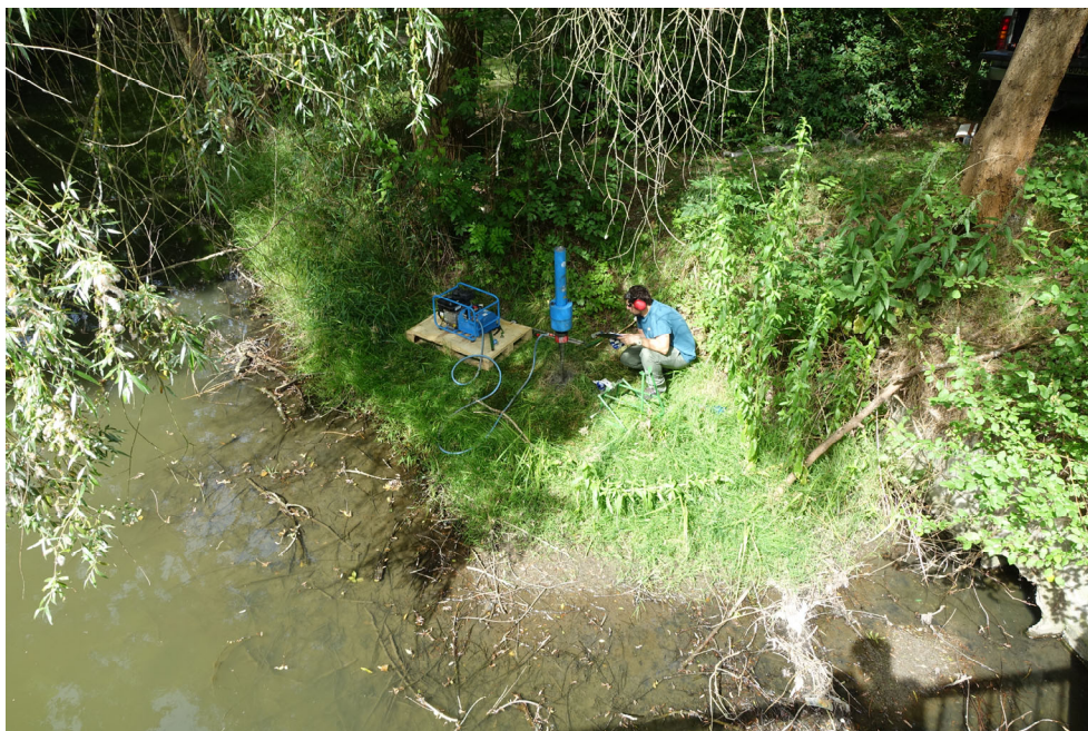
Obrázek 3. Provádění těžké dynamické penetrace DP1, pohled z mostu.
